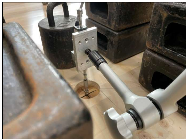
Foto 16: Nedbøjningsudstyr placeret midt gulv igennem plade
