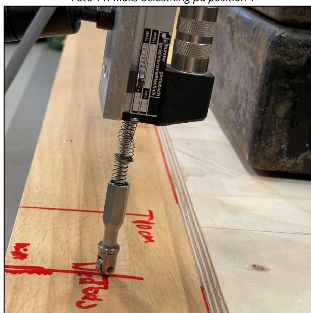
Foto 13: Nedbøjningsudstyr placeret 5 cm fra kant
